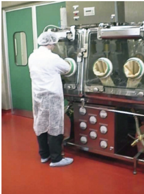
Figura. 22 - Foto di un isolatore
