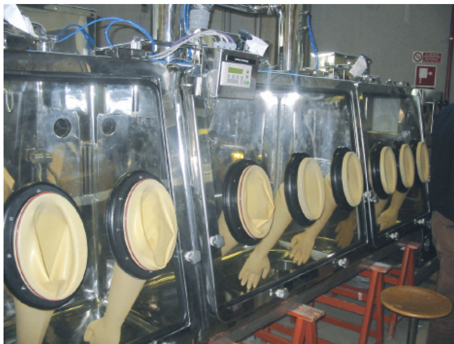
Figura. 38 - Foto di isolatore a doppia camera
