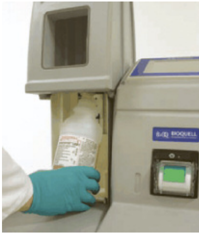
Figure. 26-27 – Alcuni dei più comuni sistemi di generazione, diffusione e successivo abbattimento del VHP
