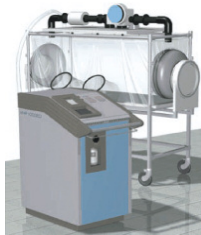
Figure. 26-27 – Alcuni dei più comuni sistemi di generazione, diffusione e successivo abbattimento del VHP
